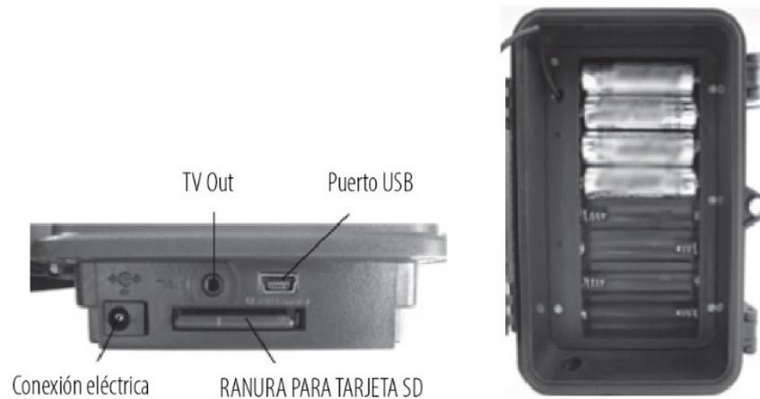
**FIGURA 21:** Ejemplo de ubicación de la tarjeta de memoria y baterías en la cámara.
