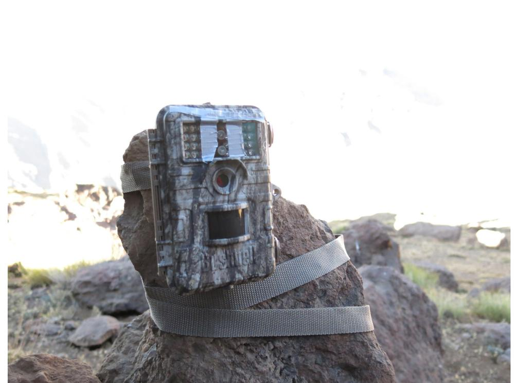
**FIGURA 14:** Ejemplo de leds tapados en la cámara con cinta adhesiva, evitando sobreexposición de fotografías © Nicolás Lagos.
