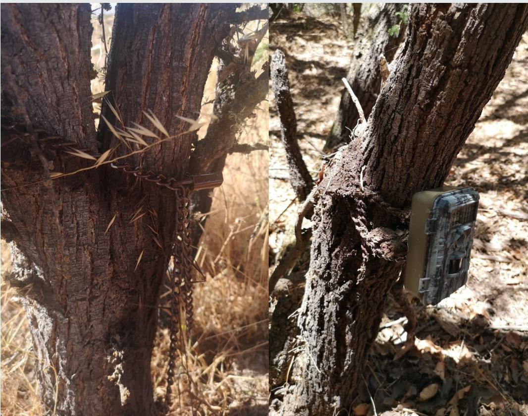
**FIGURA 10:** Imagen de trampa cámara aseguradas con cadenas.
