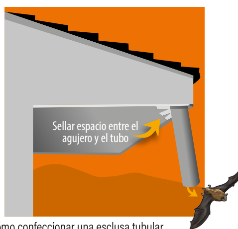
Modelo de cómo confeccionar una esclusa tubular.
