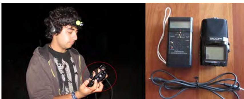
**Figura 10** | Equipo de detección acústica Pettersson D240x y grabadora digital Zoom H2n utilizado para el registro de pases de ecolocación de murciélagos en los transectos.
