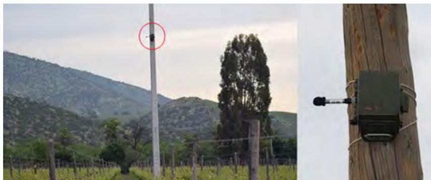
**Figura 9** | Equipo de detección acústica SongMeter SM4BAT FS utilizado para el registro de pases de ecolocación de murciélagos en los puntos fijos.
